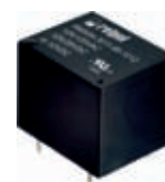
Fot. 5. RM50N – przekaźnik miniaturowy, znamionowy maksymalny prąd obciążenia 12 A/125 V AC; 12A/ 28 V DC
