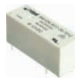
Fot. 8. RM12N przekaźnik miniaturowy, maksymalne obciążenie 8A/250V AC, 8A 30V DC dla wersji 1P
