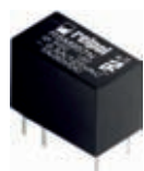
Fot. 2. RSM957N przekaźnik subminiaturowy, 1 zestyk przłączny, znamionowy maksymalny prąd obciążenia: 0,5A / 125 VAC, 1A 30 VDC
