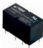
Fot. 3. RSM822N przekaźnik subminiaturowy, 2 zestyki przełączne, znamionowy maksymalny prąd obciążenia: 0,6A / 125 VAC, max 3A 30 VDC
