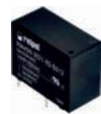
Fot. 6. RM45N – przekaźnik miniaturowy, znamionowy maksymalny prąd obciążenia 5A/250 V AC dla wersji 1Z oraz 10 A/125 V AC; 5A/28 V DC
