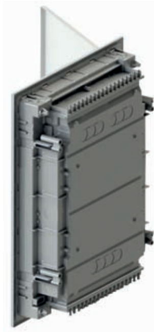
Rys. 4. W celu zapewnienia instalatorowi pewności montażu, konstruktorzy wprowadzili na kolumnie rozdzielnicy oraz na wysuwanych przepustach wycięcia trasujące służące do obrysowania otworu montażowego.
