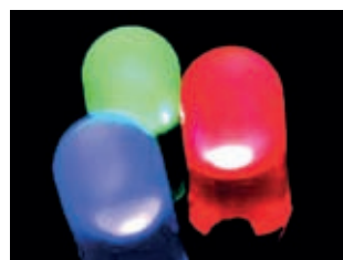
Rys. 4. Podstawowe barwy struktur elektroluminescencyjnych: dioda R - czerwona, G - zielona i B niebieska
