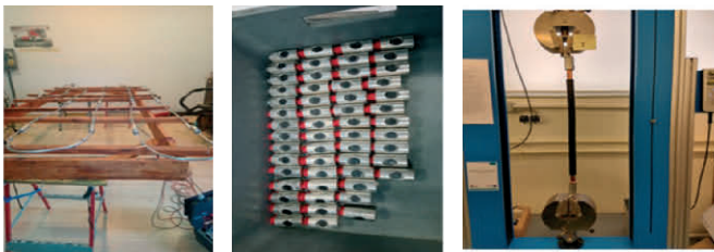
Fot. 6. a) pomiar rezystancji b) test poprawności zerwania c) badania wytrzymałości
