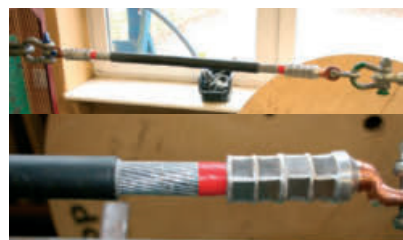
Rys. 5 Zdjęcie próbki na stanowisku do próby wytrzymałości mechanicznej.
